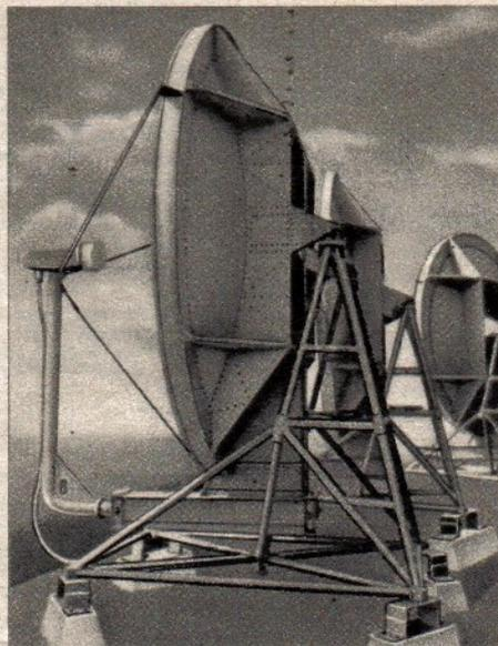
Abb. 5. Genaue Streckenführung der Fernseh-Programmstrecke Hamburg-Köln mit Höhenangaben, Entfernungen und kritischen Überreichweiten-Winkeln. Abb. 6 (links), Parabolrichtantennen (3 m Ø) für  $\lambda = 15$  cm, wie sie in ähnlicher Form für die Fernseh-Programmstrecke Hamburg-Köln verwendet werden
